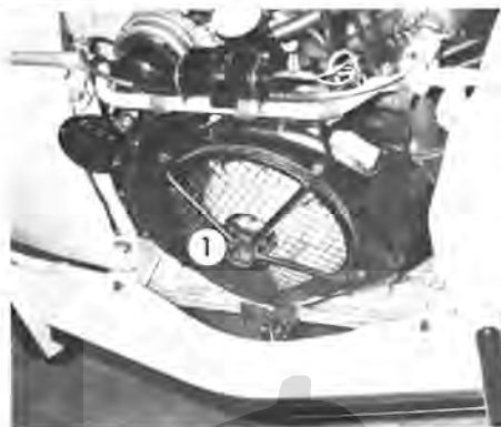
Abb. 41 – Anlassen mit der Andrehkurbel 1 Öffnung zum Einführen der Andrehkurbel
