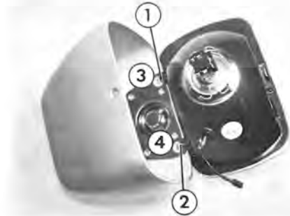
Abb. 35 – Scheinwerfer 1 - 2 Blechzungen 3 - 4 Knöpfe aus weißem Kunststoff
