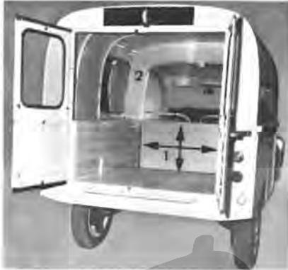
Abb. 23 – 1 Trennwand hinter den Vordersitzen 2 Feststehende Seitenfenster (auf Wunsch)
