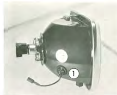
Abb. 36 – Vorderes Standlicht 1 Fassung
