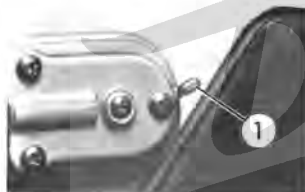
Abb. 2 – Rechte Vordertür (von innen) 1 Verriegeln
