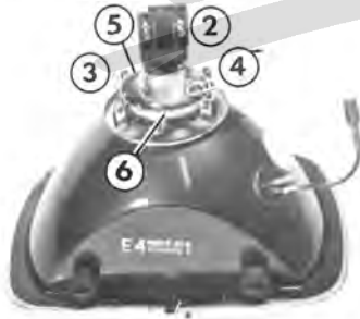
Abb. 34 – Scheinwerfer 2 Kontaktstück 3 - 4 Haltefedern 5 Glühlampenring 6 Einstellzapfen
